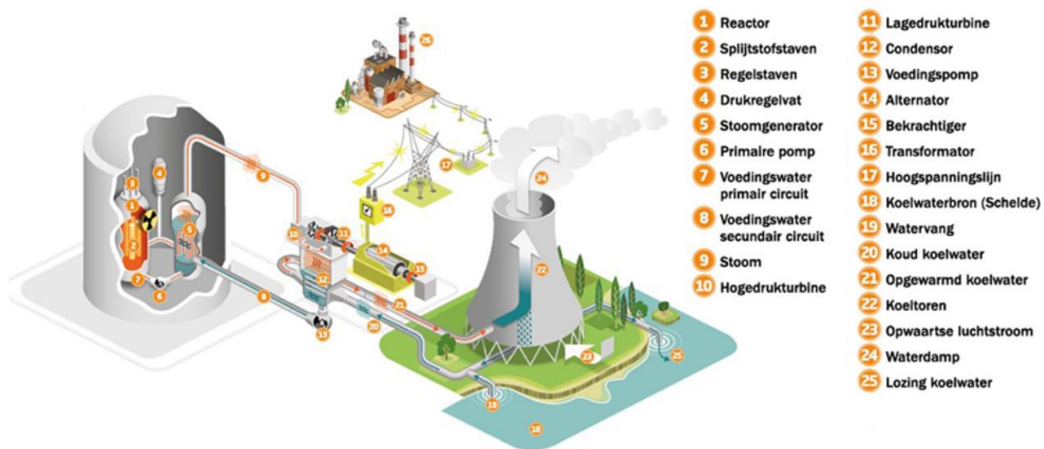
De verschillende onderdelen van een kerncentrale van het type PWR (bron: ENGIE Electrabel).
