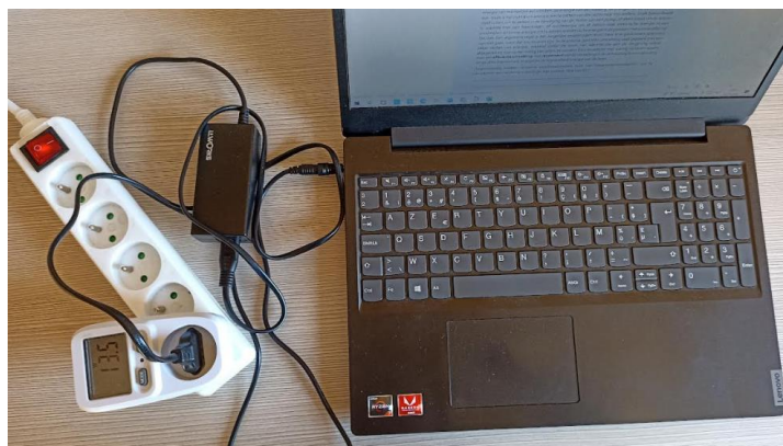
Figuur 3: Voorbeeld proefopstelling vermogen van laptop meten met een wattmeter
